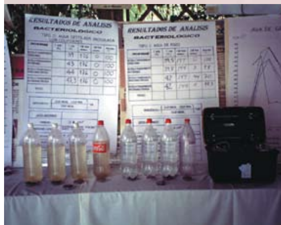
Analyses de la qualité de l'eau par le kit d'analyse de terrain DelAgua durant un atelier de démonstration SODIS afin de montrer son efficacité
