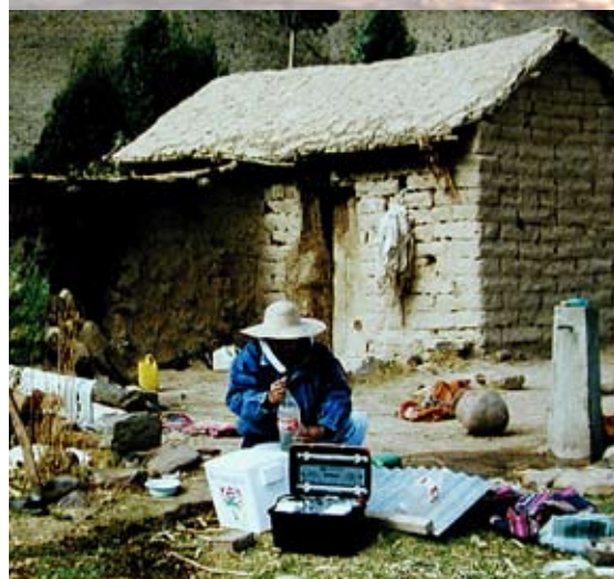
Utilisation du kit de terrain DeAgua pour tester la qualité de l'eau traitée par SODIS, ainsi que l'eau brute.
